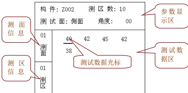
图 2-4 超声回弹的回弹测试界面
