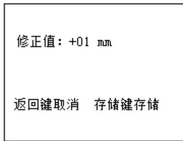
图 2-12 钢筋修正界面
