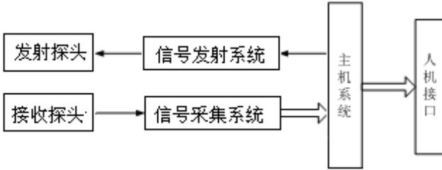
图 1-1 非金属板厚度测试仪工作原理框图
